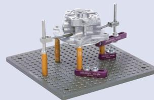
Eco-fix solution de bridage modulaire :
