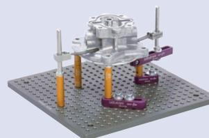
Eco-fix solution de bridage modulaire :
