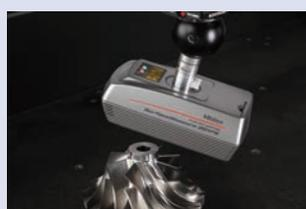
Possibilité de scanner des pièces complexes avec précision et permettant d'obtenir une précision de balayage très élevée.
