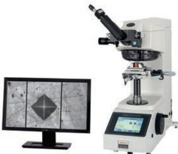
Système de caméra HDMI Vickers
