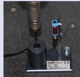
Solution intégrée StyliCleaner pour le nettoyage des stylets
