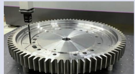
Scanning avec capteur SP80
