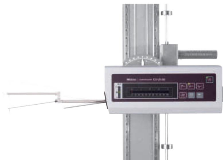
CV-2100 Fonction de montée/descente automatique du stylet
