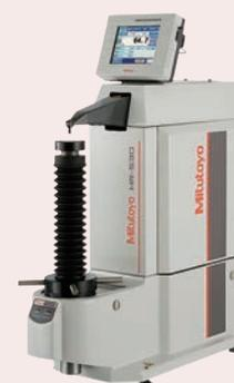
Testeur de dureté portable
