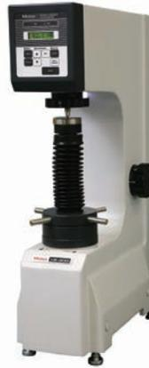
Testeur de dureté double (Rockwell/
