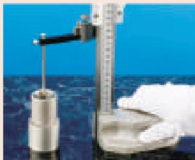
Accessoire pour la mesure de profondeur
