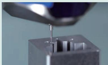
Scanning d'un moule avec MPP-Nano
