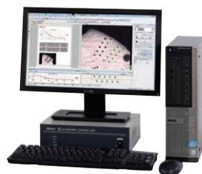
Logiciel AVPAK-20 11AAC666 pour les systèmes d'essai de dureté automatique. Logiciel qui prend en charge le contrôle, les tests et la création rapport relatif aux tests de dureté. Prise en charge de paramétrage et de mesure automatique.
