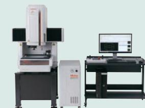
**Machine de mesure 3D CNC pour micro-géométrie**
