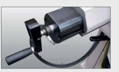
Morsa chiusura materiale in ghisa a posizionamento manuale, dotata di cilindro di chiusura idraulico. *Material clamping vice made of cast iron with manual positioning and hydraulic locking cylinder.*
