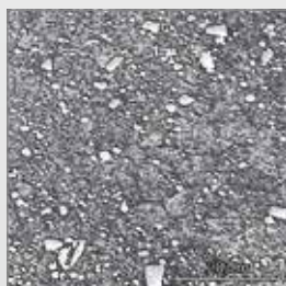
Structure du matériau de la pointe de dent (M42 HSS)
