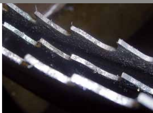
Dépôts de copeaux à la base des dents
