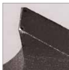
Dent intacte après rodage
