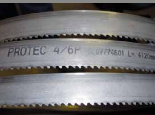
Lame de scie à ruban avec traces d'usure latérales
