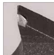
Dent endommagée sans rodage
