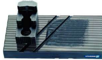
Spannbacke über der Schleifpaste aufsetzen, in die Verzahnung führen und hin und her bewegen Insert jaw on top of the grinding compound, guide it into the serration and move back and forth
