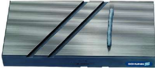
Bei gehärteten Spannbacken Schleifpaste am äußeren Rand auftragen With hardened jaws apply grinding compound near the outer edge
